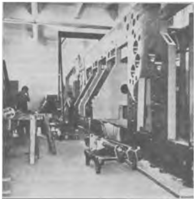
FIG. 15 PRESSE D'IMPRIMERIE DE JOURNAUX KOEBAU „COURIER 25" POIDS APPROX. 85 t, 25.000 JOURNAUX/HEURE CHACUN DE 32 PAGES, LA PHOTOGRAPHIE A ÉTÉ PRISE LORS DE LA ÉRECTION, LA MACHINE EST MONTÉE SUR UN SOCLE EN CÉMENT SOUS LEQUEL SONT PLACÉES DES PLAQUES D'ISOLATION MAFUND
