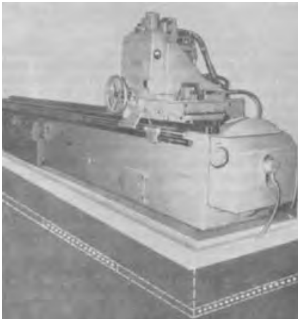
FIG. 14 SOCLE IMERGÉ D'UNE MACHINE A RABOTER MONTÉE SUR PLAQUES D'ISOLATION MAFUND
