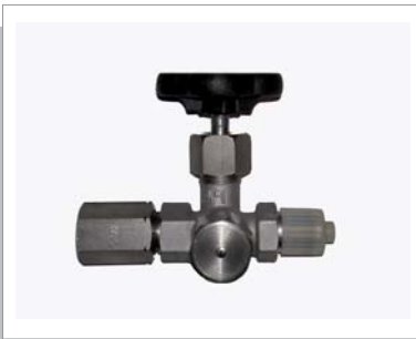
Manometer-Absperrventil gem. DIN 16270 Anschluß G 1/2" : Zapfen-Spannmuffe Form A, mit Prüfzapfen M 20 x 1,5
